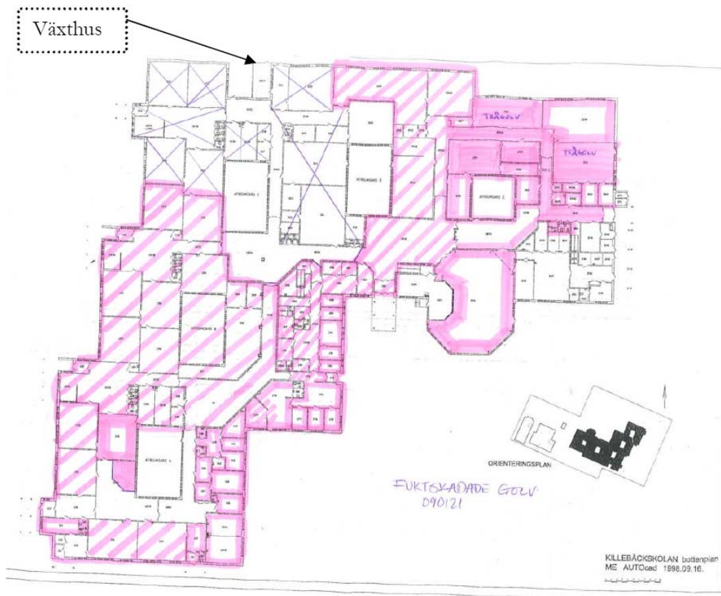
Figur A 10. Fuktskador i golv, kryssade delar rivna.
