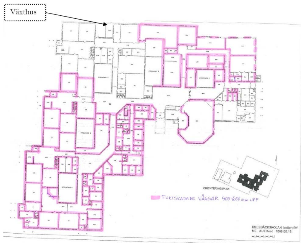
Figur A 11. Fuktskador i väggar 40-60 cm upp, kryssade delar är rivna.
