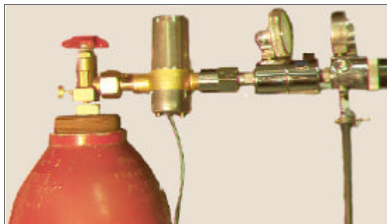
Bild H.8.1, Visar hur förvärmaren var monterad på en koldioxidflaska.
