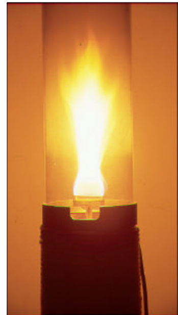
Bild I.1.1, Försökseldning i Burner Cup. Observera den relativt häftiga flammen.
