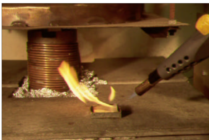
Bild K.5.1, Visar hur provbiten antänds med en gaslåga. Observera aluminiumlådan som omger provbiten.
