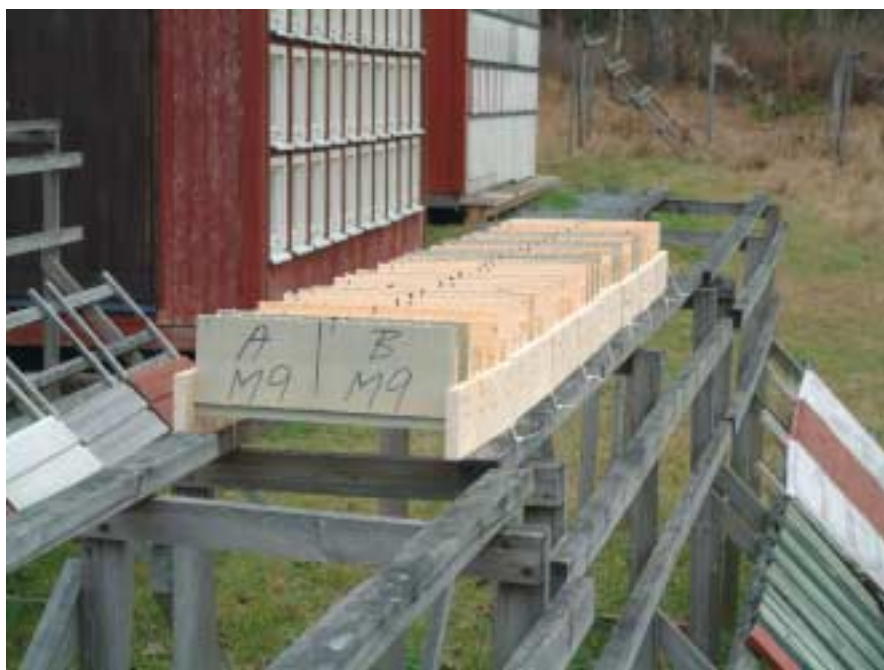
Fältförsök om eventuell korrosion på metaller i brandskyddat trä.
