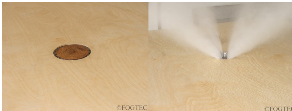
Figur 17 De dolda munstycken, så kallade ”pop-up” munstycken, som användes vid försöken. Foton publicerade med benäget tillstånd av FOGTEC Brandschutz GmbH & Co. KG.
