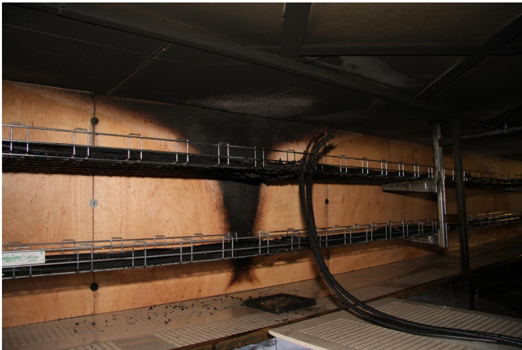
Figur 7 Brandskadorna efter ett försök med det traditionella sprinklersystemet (referensförsök). Foto publicerat med benäget tillstånd av tillverkaren.
