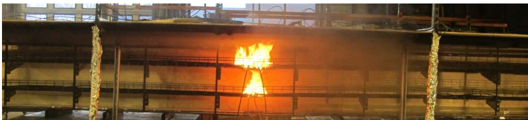
Figur 9 Branden strax efter att två munstycken aktiverat i ett försök med ett lågtryckssystem. Foto publicerat med benäget tillstånd av tillverkaren.
