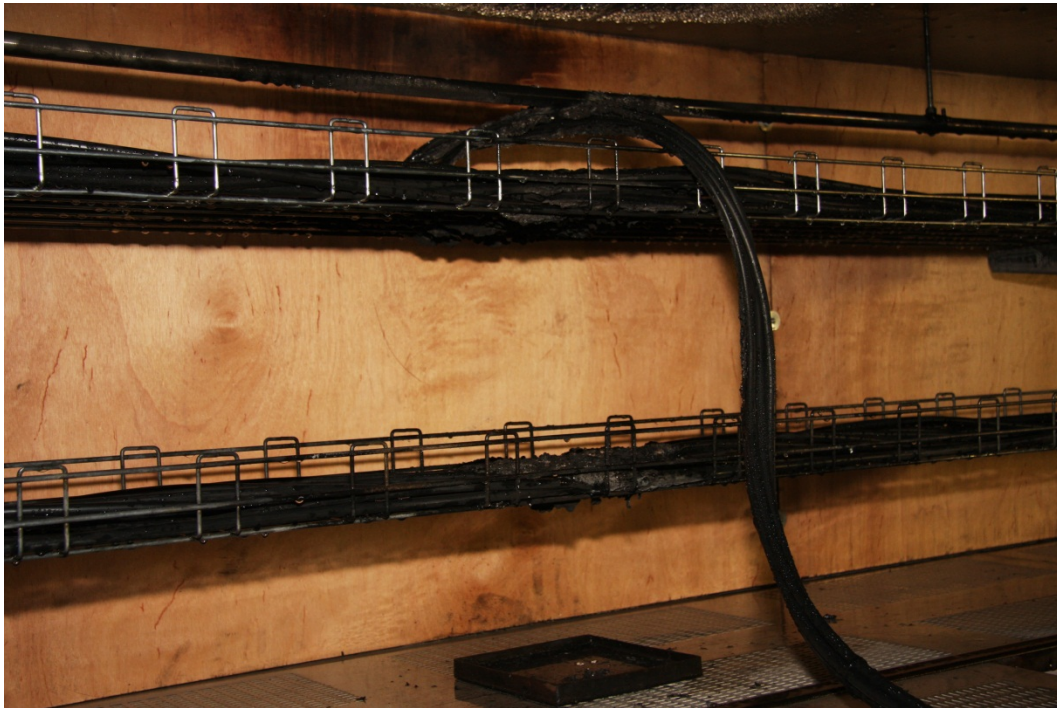
Figur 8 Brandskadorna efter ett försök med högtryckssystemet. Foto publicerat med benäget tillstånd av tillverkaren.
