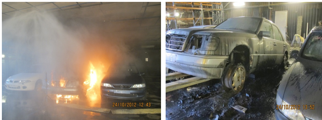
Figur 4 Branden i ett av försöken med lågtryckssystemet sekunderna efter att två munstycken aktiverat samt brandskadorna efter försöket [8].
