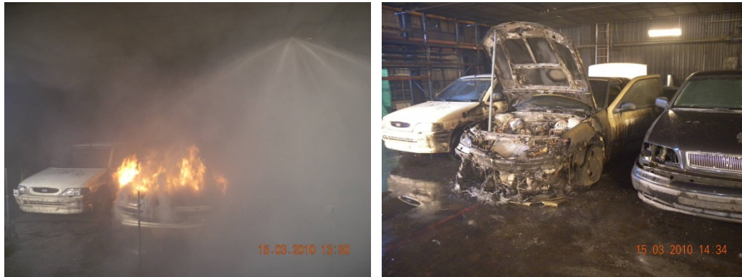
Figur 3 Branden i ett av försöken med högtryckssystemet sekunderna efter att det första munstycket aktiverat samt brandskadorna efter försöket [7].
