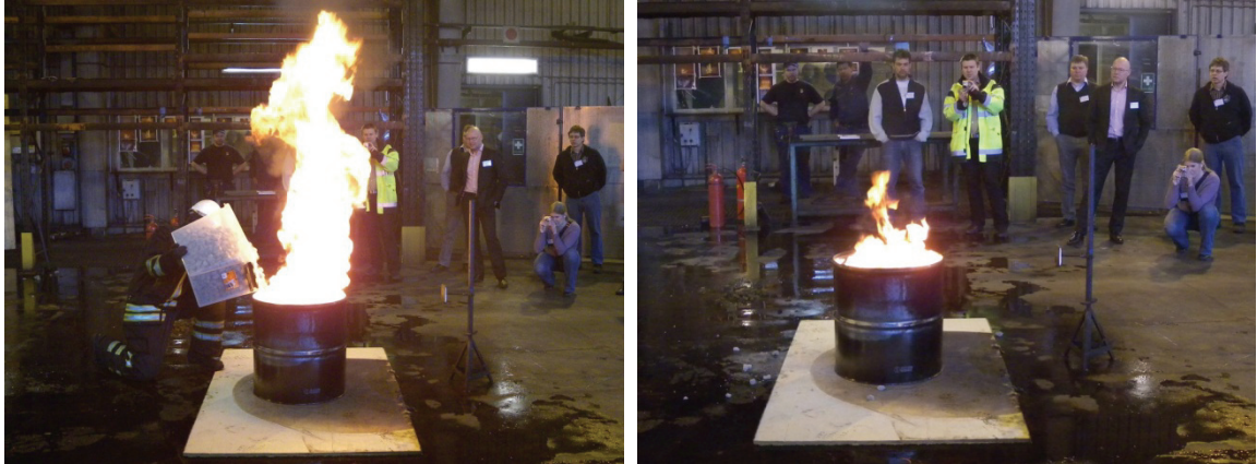
Figur 18 Bilder från Test 6 som visar när det expanderade glaset precis började fyllas på i bålet efter 1 minuts förbrinntid (vänster) och mindre än 1 minut senare när branden dämpats ner (höger).
