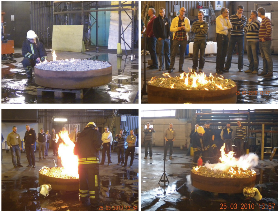
Figur 14 Bilder från test 4 som visar bålet strax efter tändning (övre vänster), ca 4 minuter efter tändning (övre höger), efter ca 11 minuter då bädden stördes genom att skyffla undan expanderat glas (nedre vänster) samt efter ca 14 minuter då branden släcktes manuellt (nedre höger).
