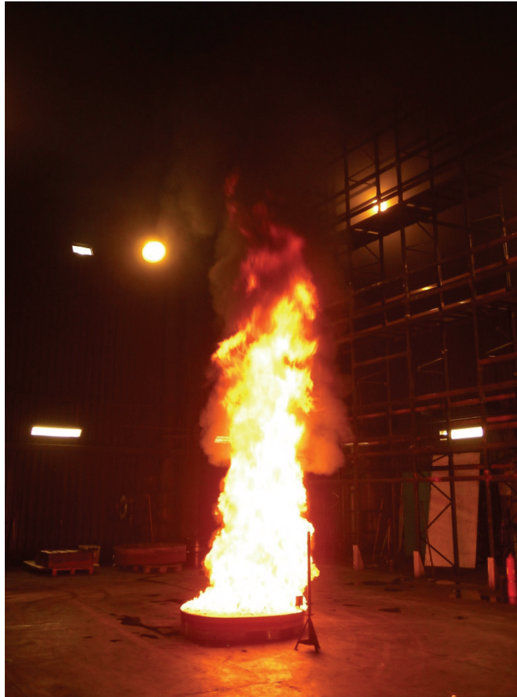
Figur 8 Vid det fribrinnande försöket var flammhöjden ca 5-7 m och bränslet förbrukades på knappt 5 min, dvs med en avbrinningshastighet på ca 4 mm/min vilket motsvarar en brandeffekt på ca 2,5-3 MW
