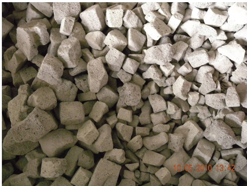
Figur 5 ® HASOPOR Skumglas är ett lättfyllnadsmaterial i granulatform med granulat med en storlek på ca 10-60 mm. Den kvalitet som användes vid försöken ( ® HASOPOR Lätt) har en korndensitet på ca 300 kg/m 3 (torr) och en bulkdensitet på ca 180 kg/m 3 .
