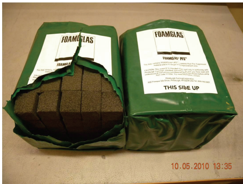
Figur 6 FOAMGLAS® PFS består av enskilda kuber med måtten 37 x 37 x 44 mm. Dessa förpackas i en plastförpackning bestående av dubbla lager av en UV-resistent PE-plast. Varje förpackning innehåller 125 kuber (staplade 5 x 5 x 5) vilket ger förpackningen en storlek av ca 190 x 190 x 235 mm. Ett paket väger ca 1,9 kg.
