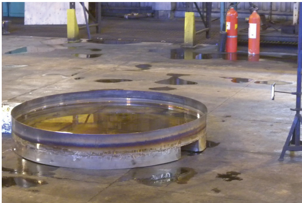
Figur 7 Försöksbål 1,73 m 2 med plattermometern monterad på 0,5 m avstånd till höger om bålet.
