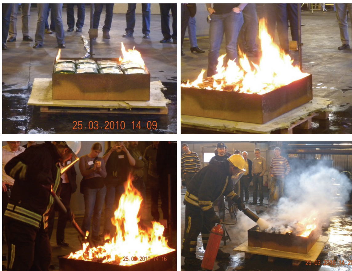
Figur 16 Bilder från test 5 som visar bålet ca 1 minut efter tändning (övre vänster), ca 7 minuter efter tändning (övre höger), efter ca 8 minuter då kuberna rörde runt för att täcka igen spalter mellan kuberna (nedre vänster) samt efter ca 12 minuter då branden släcktes manuellt (nedre höger).
