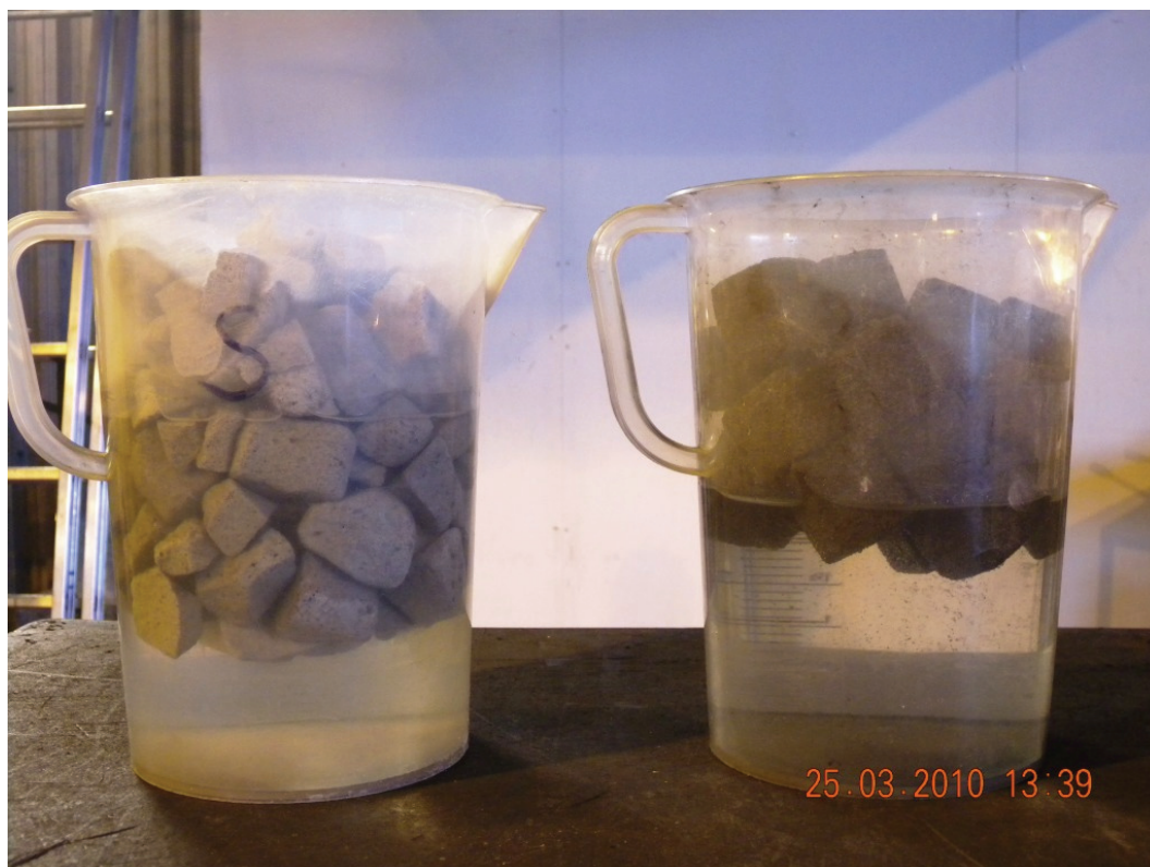
Figur 20 Foto som visar flytförmågan på vatten för ® HASOPOR Lätt respektive FOAMGLAS ® PFS (endast kuber).
