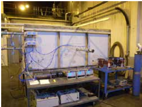
Figur 11 I bilden visas modellrummets baksida med kanal (B) och mätutrustning för CO, CO 2 och O 2 .
