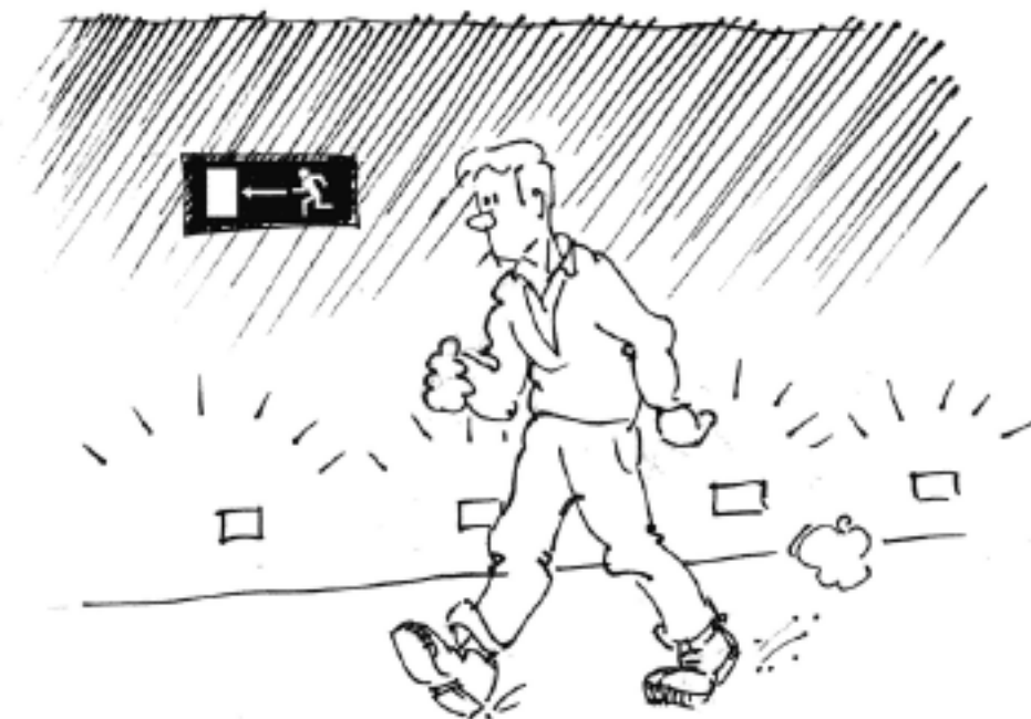
Figur 12: Placering av nödbelysning ska placeras lågt och ha minst 1 lux längs hela gångstråket (hämtad från Brandskyddshandboken med tillåtelse).
