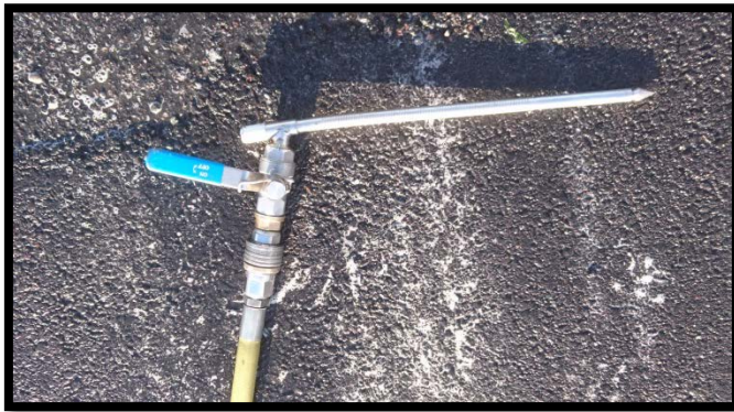
Figur 12: Dimspik med fjäder för att undvika att dimspiken sätts på och sedan inte stängs av.
