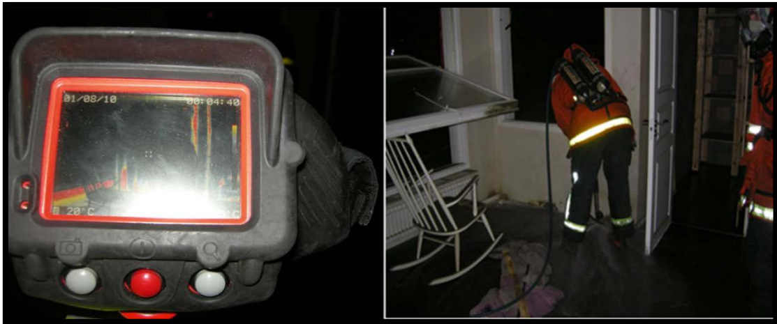
Figur 9: Till vänster syns IR-bild och till höger samma situation med vanlig kamera, det går att notera gungstolen i IR-bilden. Hur tolkar du brandförloppet?
