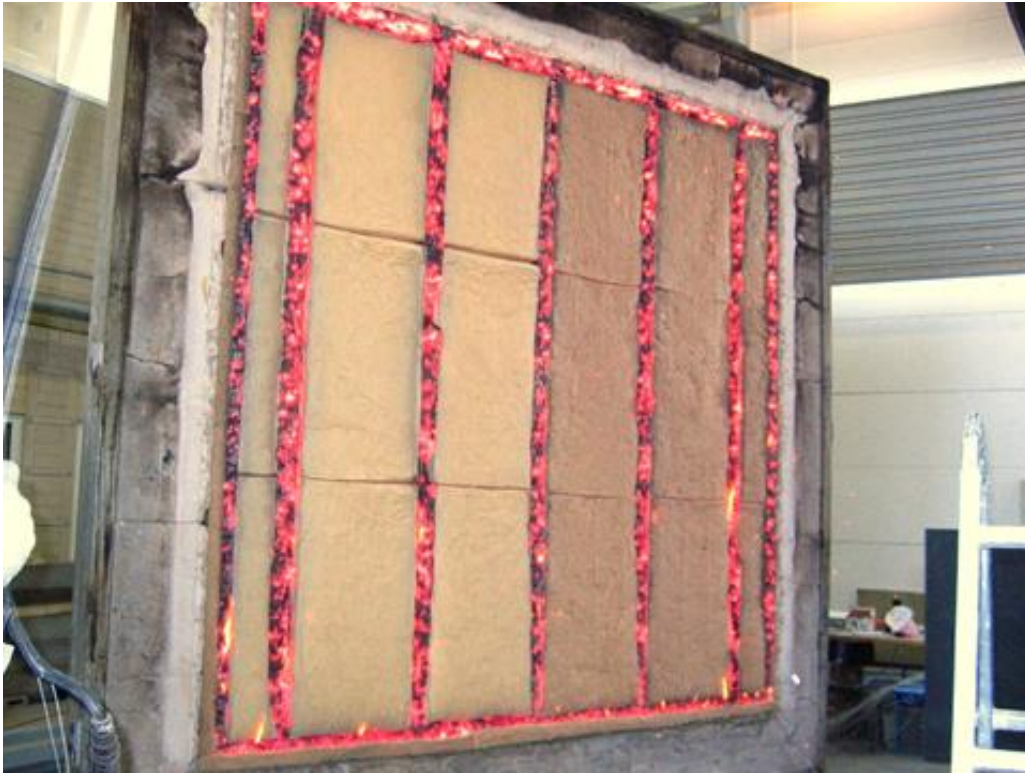
Figur 4. Stenull som fixerats genom överdimensionering efter 60 minuters brandprov.
