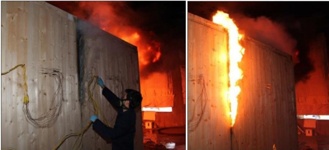
Figur 10. Brandspridning genom CLT anslutningar enligt McGregor (2014)
