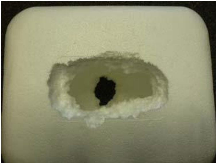
Figur 5 Nedbrytning av cellplast efter 10 minuters exponering av 1 dl av en ester som används som fasomvandlingsmaterial 68 .
