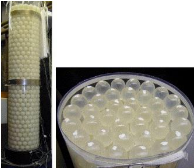
Figur 9 Cylindrisk behållare fylld med paraffin makroinkapslad i sfärer med 50 mm diameter. Cylindern integreras i ventilationssystemet så att luften flödar genom behållaren 80 .
