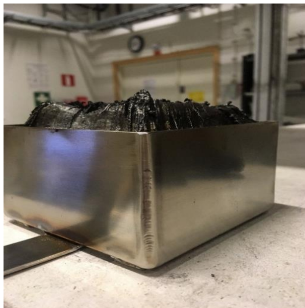
Figur 10 Provet med potatismjöl efter genomfört experiment. Provet har expanderat och rest sig cirka en centimeter i behållaren. Ytan är porös och skör.
