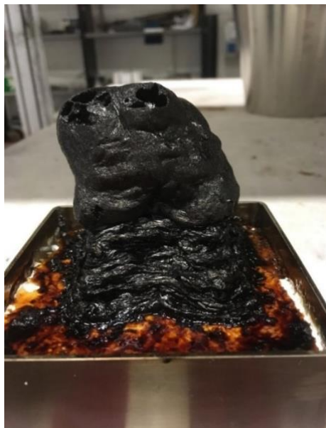
Figur 12 Provet med florsocker efter avslutad uppvärmning i konkalorimetern. Florsockret, som är i pulverform, smälte och började koka varpå en korvliknande formation växte fram innan antändning skedde.
