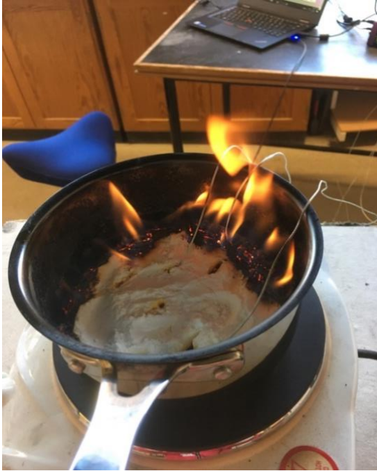
Figur 18 Antändning av potatismjöl och smörpulver. Potatismjölet drar ihop sig och pyrolysgaserna koncentreras runt kastrullens kanter. Vid kontakt med luftens syre sker antändning. I mitten ligger kallt, opåverkat pulver kvar. Smörpulvret börjar koka och bubbla i hela materialet vilket resulterar i en kraftig brand över hela kastrullen.
