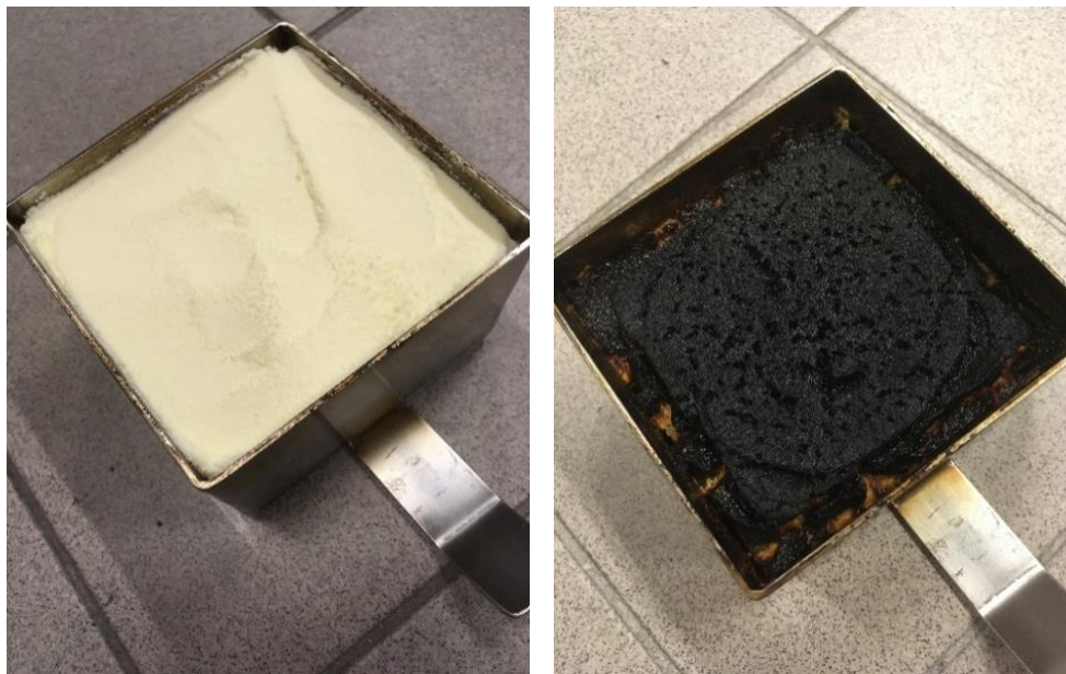
Figur 9 Smörpulver innan och efter genomfört test. Antändning skedde relativt snabbt och ytan blev mitt i mellan hård och porös.
