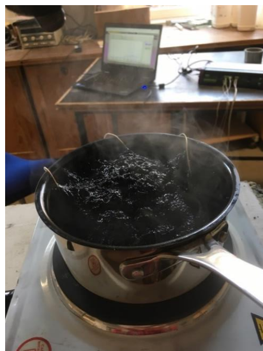
Figur 19 Proteinpulver och florsocker. Inget av materialen ledde till antändning. I bilden till höger kan ses hur florsockret har expanderat kraftigt i kastrullen och är nu bara ett hårt och sprött skal.
