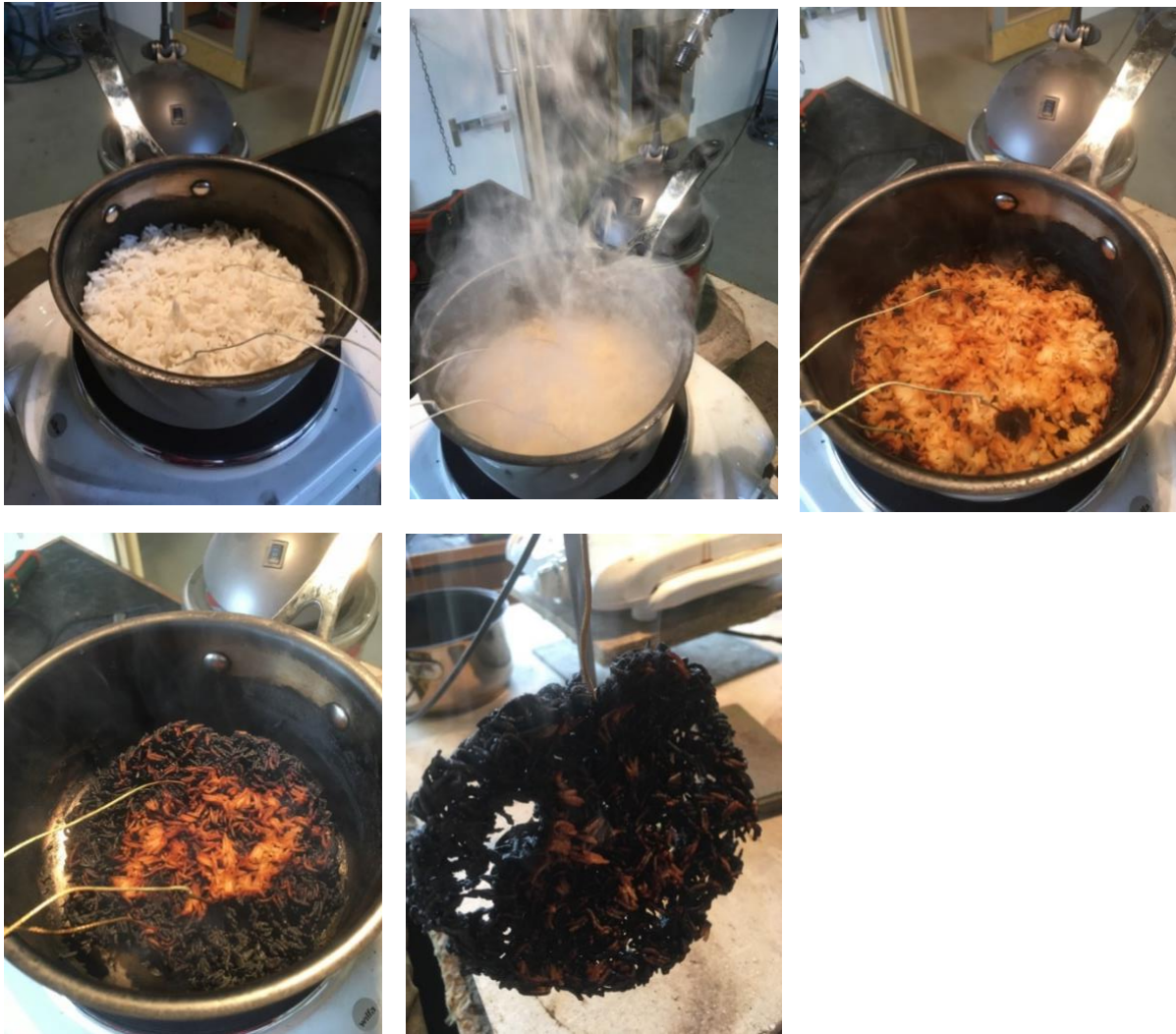
Figur 24 Torrkökning av ris. Rökutvecklingen startade efter 5:30. Därefter förkollnade provet långsamt. Provet sprakade och knäppte under hela försöket
