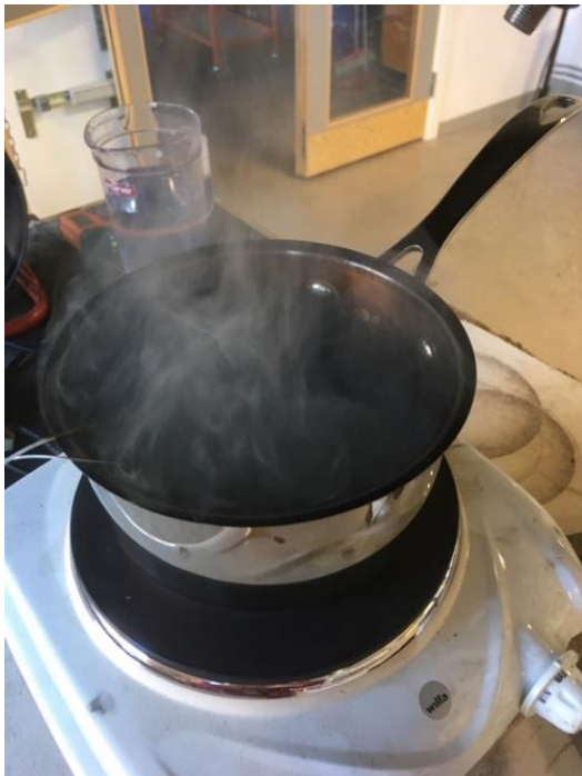
Figur 19 Proteinpulver och florsocker. Inget av materialen ledde till antändning. I bilden till höger kan ses hur florsockret har expanderat kraftigt i kastrullen och är nu bara ett hårt och sprött skal.
