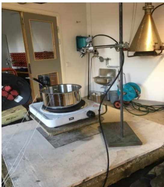
Figur 8 Försöksupställningen på kokplatta. En kokplatta står uppställd på en våg och i botten på kastrullen sitter tre termoelement fasttejpade. Pyrometern är uppställd med hjälp av ett stativ och mäter temperaturen på livsmedlets yta.
