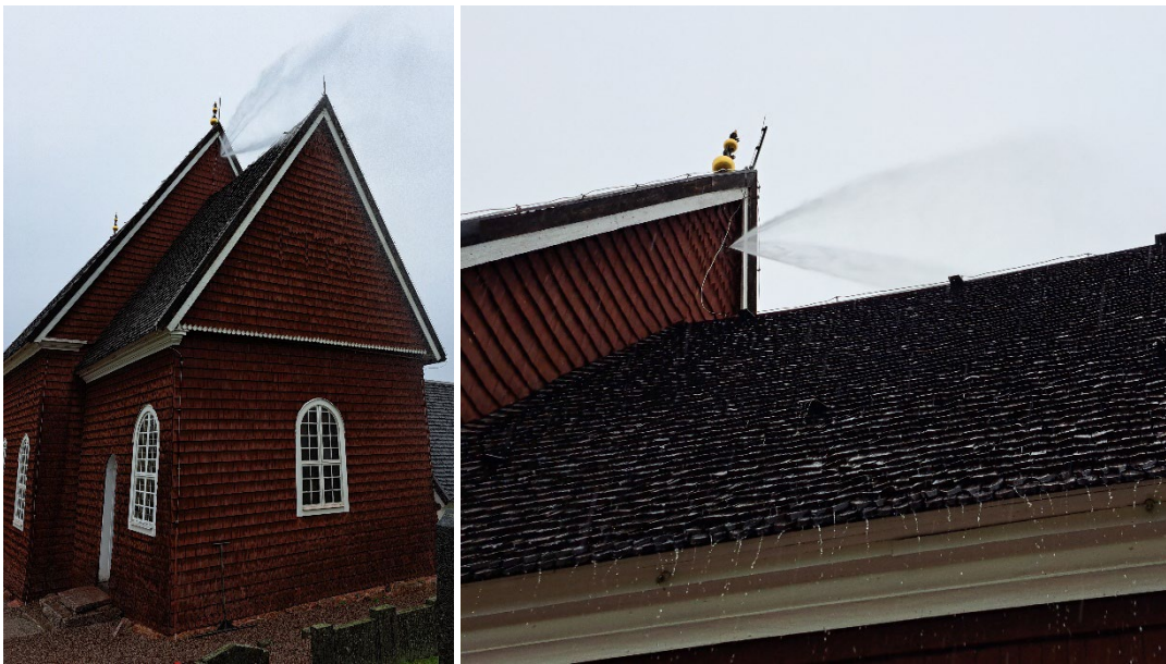
Figur 50 Provning av fördröjningstiden för ett traditionellt sprinklersystem med en enda torrörslarmventil vid platsbesöket 2023. Provventilens fast monterade sprinklermunstycke mynnar genom en av kortsidornas fasad. Foton: Magnus Arvidson, RISE.
