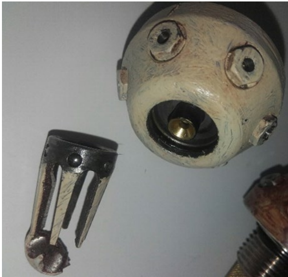
Figur 6 Automatiskt munstycke (högtryckssystem) installerat under takfot som aktiverade utan brand. Foto: Okänd.
