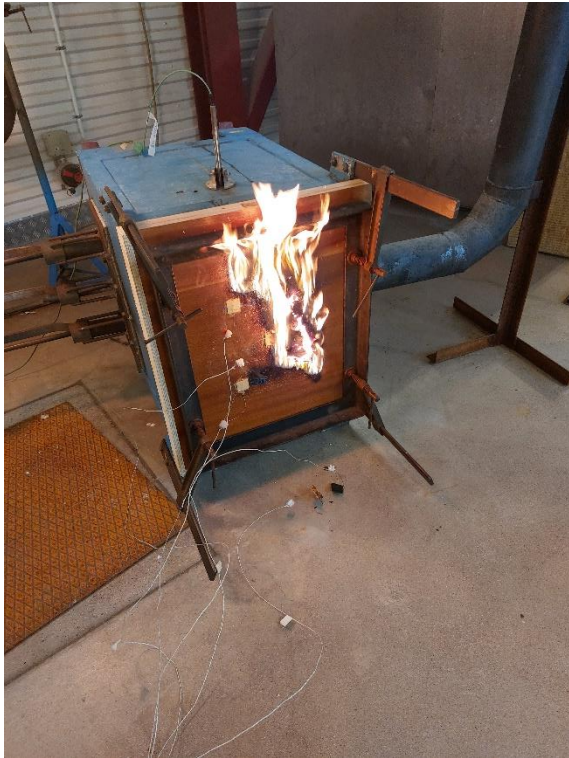
Figure 3. Provföremålet tar eld efter 29 min av provet och integriteten är således fallerad.
