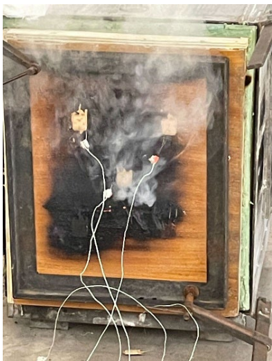
Figur 29. Provföremålet strax innan genombränning.
