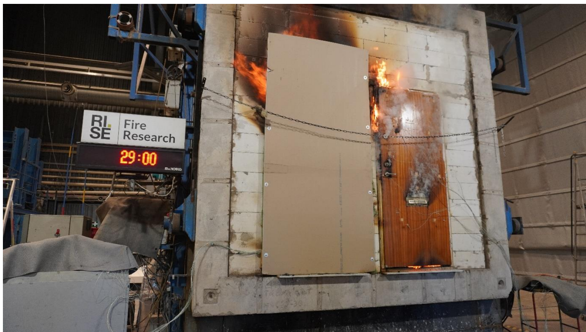
Figure 5. Lågor med längre varaktighet än 10 sek uppstår på provföremål B efter ca 29 min av provet.
