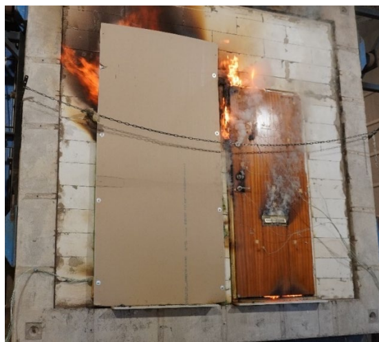
Figur 51. Lågor med längre varaktighet än 10 sek uppstår på provföremål B efter ca 29 min av provet.
