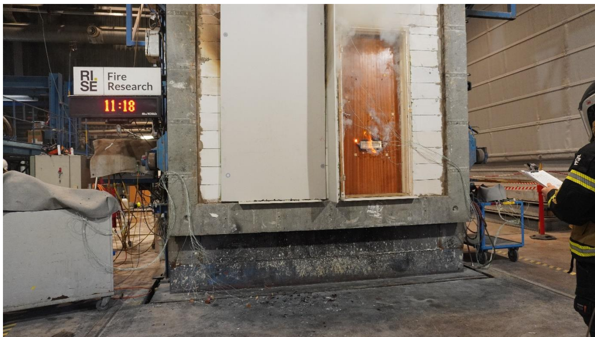
Figure 5. Sticklågor kommer ut vid brevinkastet på provföremål B efter drygt 11 min.
