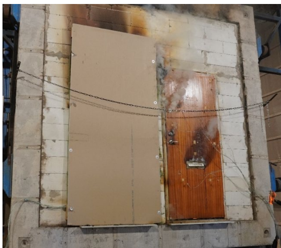
Figur 50. Brinnande bomullstuss efter integritetstest efter drygt 23 min vid tröskel på provföremål B. Provföremål A har täckts med en gipsskiva för att kunna fortsätta provningen och utvärderingen av provföremål B.
