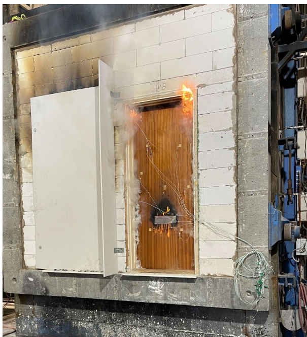
Figur 39. Dörrtyp B efter 16 min. Täckande skiva över provföremål A.
