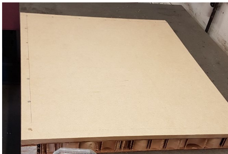
Figur 13. Dörrtyp A med en 12 mm MDF-skiva monterad.
