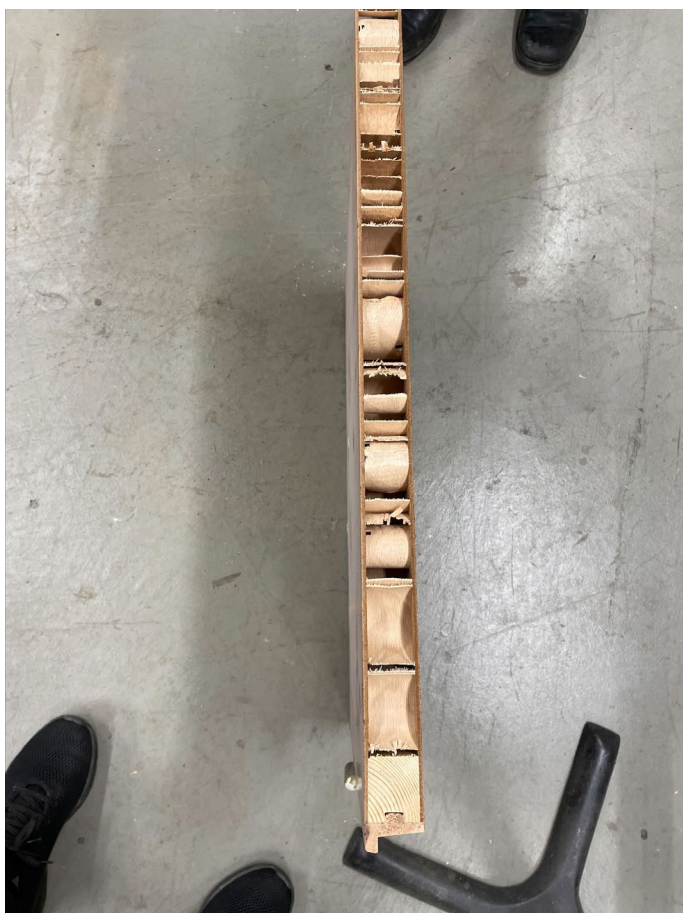
Figur 1: Provföremål A där fanerskivans tjocklek och dörrens uppbyggnad syns
