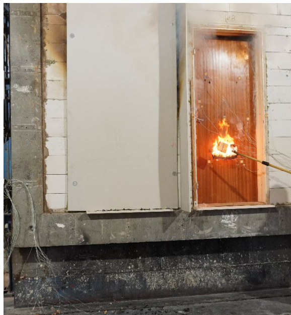
Figur 38. Integriteten för provföremål B fallerar då bomullstussen antänds efter 14 min. Täckande skiva har placerats över provföremål A för att testet ska kunna fortgå.
