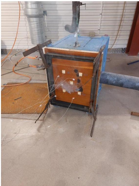
Figure 2. Provföremålet efter drygt 26 min av provet när de svarta fläckarna uppstod.
