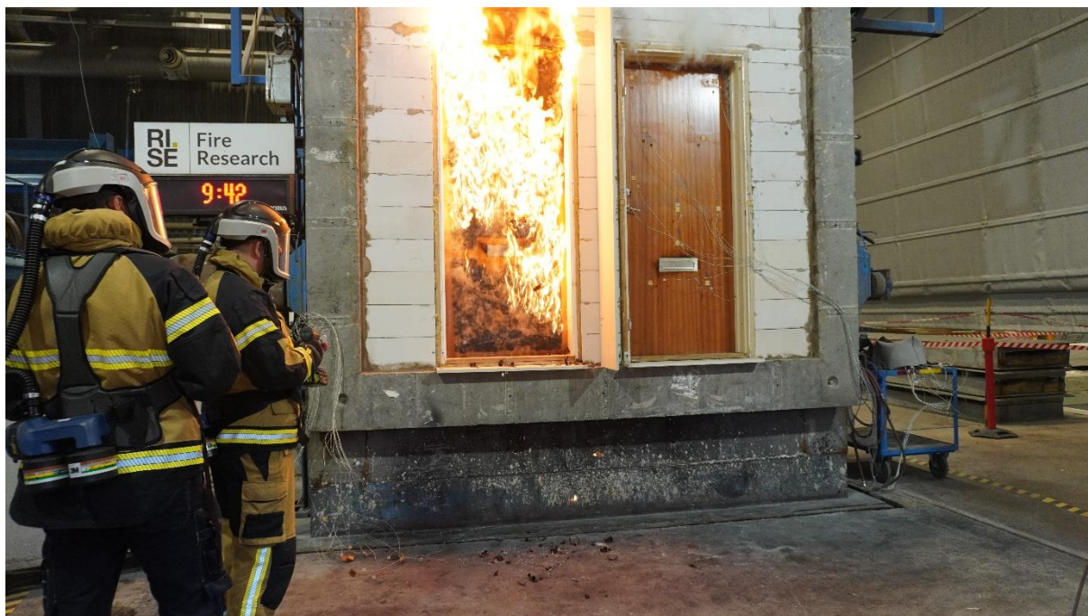
Figure 3. Provföremål A tar eld efter drygt 9 min av provet.
