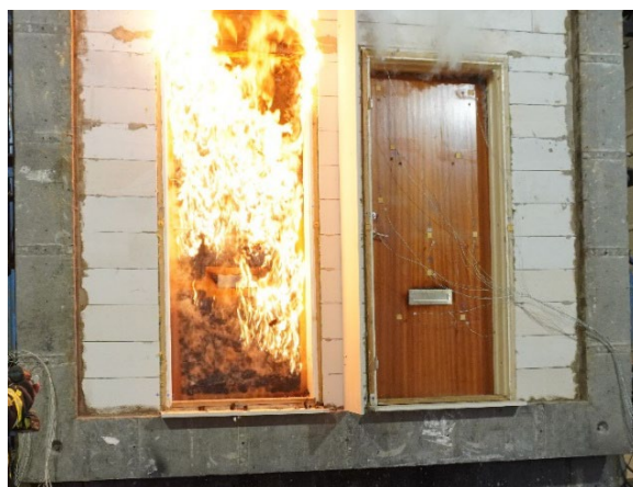
Figur 36. Provföremål A fallerar efter drygt 9 min av provet.
