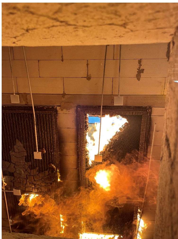
Figure 4. Vy inifrån ugnen (baksidan av provföremål) i ögonblicket då integriteten fallerar för provföremål A.
