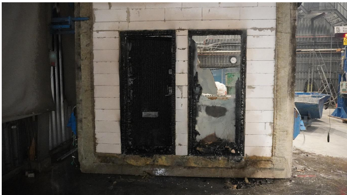
Figure 6. Den brandexponerade sidan av provföremålen efter avslutat provning. Provföremål A till höger i bild och provföremål B till vänster i bild.
