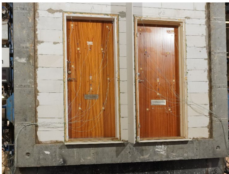
Figur 12. Provföremålen före provets start, provföremål A till höger och B till vänster.
