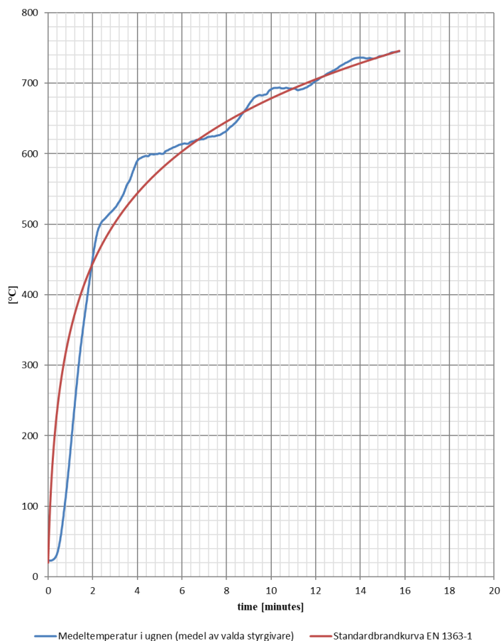
Figur 32. Medeltemperatur i ugn i jämförelse med standardbrandkurvan (EN 1363-1).
