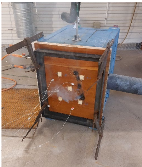
Figur 42. Provföremålet (dörrtyp A med MDF-skiva) efter drygt 26 min av provet när de svarta fläckarna uppstod.
