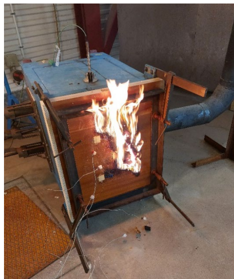
Figur 43. Provföremålet (dörrtyp A med MDF-skiva) efter 29 minuter.
