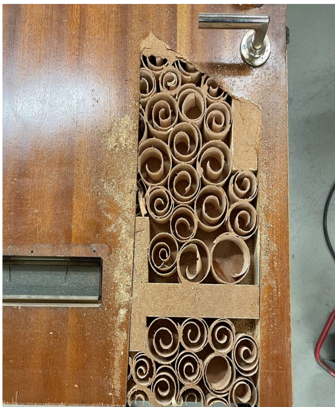
Figur 2: Provföremål A där fyllningen frilagts genom att fanerskivan tagits bort.
