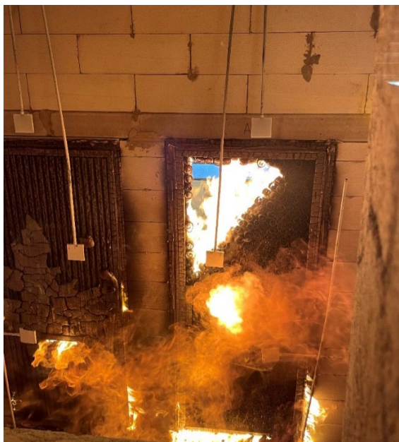
Figur 37. Vy från ugnen (baksidan av provföremål) i ögonblicket då integriteten fallerar för provföremål A.
