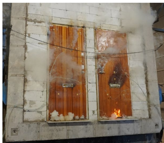
Figur 49. Sticklåga vid tröskeln på provföremål B efter drygt 16 min av provet. Lågan under provföremål B är godkänd då den var kortare än 10 sek.
