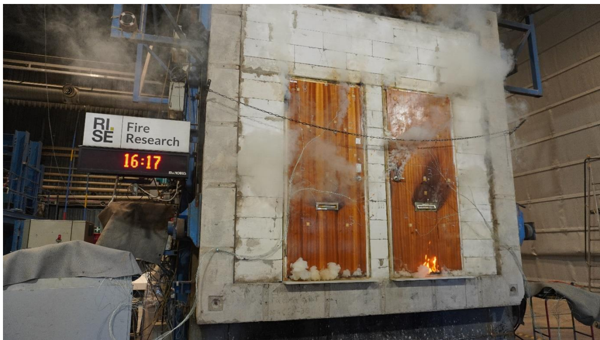
Figure 3. Sticklåga vid tröskel på provföremål B efter 16:17 min av provet.
