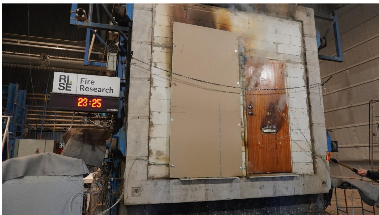
Figure 4. Brinnande bomullstuss efter integritetstest vid tröskel på provföremål B. Provföremål A har täckts med en gipsskiva för att kunna fortsätta provningen och utvärderingen av provföremål B.
