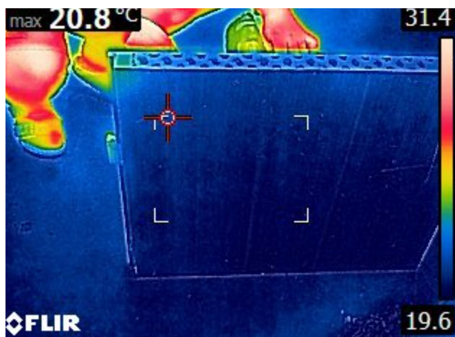
Figur 25 Dörrtyp B - icke värmeutsatt sida via IR-kamera, kort in i tidsförloppet
