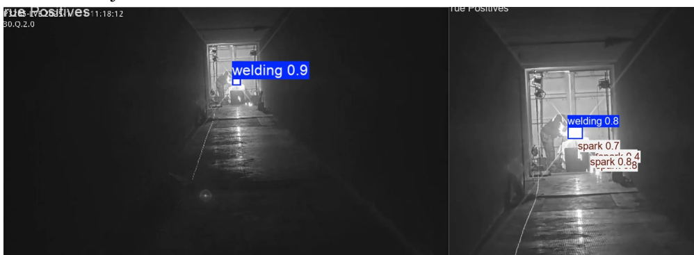
Figur 8: Coco640 (till vänster) och Coco640Cropped (till höger) använda på en bild som visar svetsning
